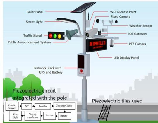
Figure 1. Smart Solar-Piezo poles
